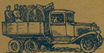
2. Наша 76-миллиметровая полковая пушка, погруженная для перевозки на грузовик. Стреляет снарядом в 6,5 килограмма на 7 километров. Вес пушки—около 740 килограммов.
