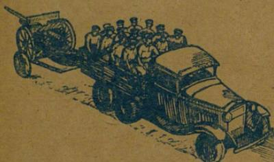
3. Наши 76-миллиметровые дивизионные пушки на подкатных тележках для перевозки за грузовиком. Пушки этого вида стреляют теперь на расстояние до 14 километров снарядом в 6,5 килограмма. Вес пушки—около 1 тонны.
