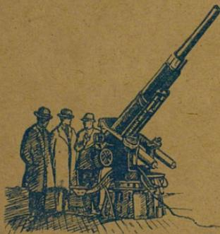
6. 76-миллиметровая американская пушка (для стрельбы по самолетам), приспособленная для автоматического управления с помощью электрического тока. Стреляет вверх на высоту до 9 километров.
